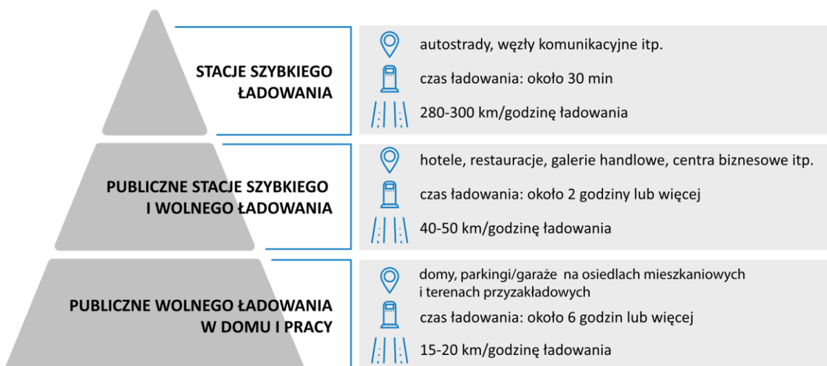
Rysunek 21: Mix infrastruktury ładowania pojazdów elektrycznych
