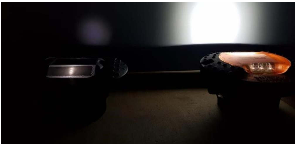
Zdjęcie 3 Na powyższym zdjęciu znajdziecie Państwo porównanie APEO z 1 diodą led na jednej stronie oraz APEO z 3 diodami led na jednej stronie.
